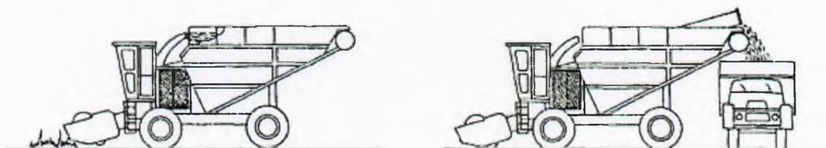
Chargeur à deux roues à décharge hydraulique
