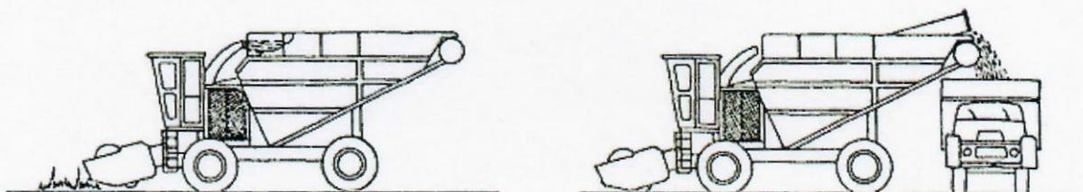
Chargeur à deux roues à décharge hydraulique
